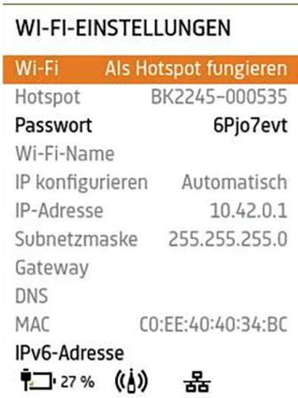
Gehen Sie zu **Systemeinstellungen** > **Netzwerkeinstellungen** > **Wi-Fi-Einstellungen**, um die Verbindung zu Wi-Fi herzustellen. Setzen Sie *Wi-Fi* auf:
