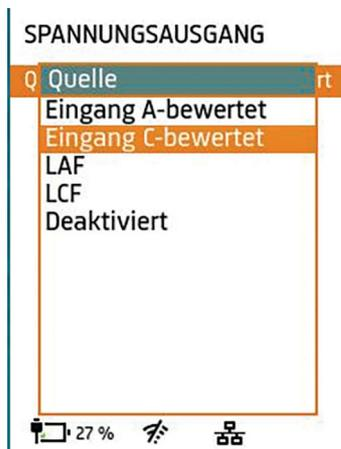
Gehen Sie zu **Systemeinstellungen** > **Spannungsausgang**, um an der USB-C-Buchse ein analoges Signal auszugeben, über den USB-C/3,5mm-Miniklinken-Adapter AO-0846.
